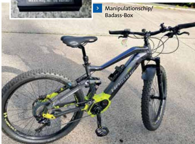
Pedelec mit angebrachter Badass-Box am Geschwindigkeitssensor (V/max ca. 50 km/h)
