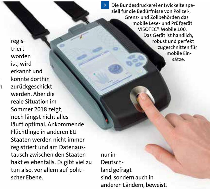
Die Bundesdruckerei entwickelte speziell für die Bedürfnisse von Polizei-, Grenz- und Zollbehörden das mobile Lese- und Prüfgerät VISOTEC® Mobile 100. Das Gerät ist handlich, robust und perfekt zugeschnitten für mobile Einsätze.
