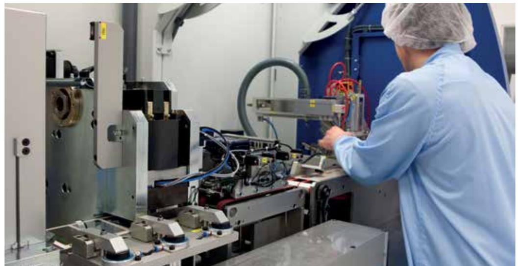
> Die Ausweiskarten werden auf das Format gestanzt und anschließend einzeln fertigproduziert.
